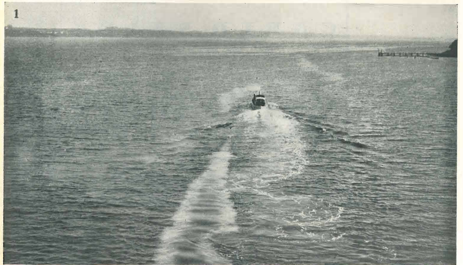
Fig. 1. Il corso del siluro sotto la superficie del mare si riconosce dalla scia visibile. Esso si sposta in direzione di un bersaglio bianco sull'orizzonte. In immediata vicinanza della rotta percorsa dal siluro corre un motoscafo che lo accompagna nel suo corso; esso ha il compito di ripescare il siluro dopo che è giunto a destinazione e di riportarlo alla base.
